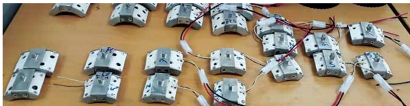
Hình 6. Các guốc cảm biến cho các cỡ ống khác nhau - EMI.
