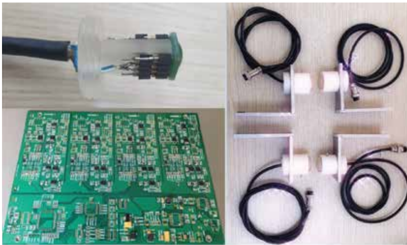
Hình 8. Cảm biến Hall phẳng, mạch điện tử xử lý và cuộn gắn cảm biến.
